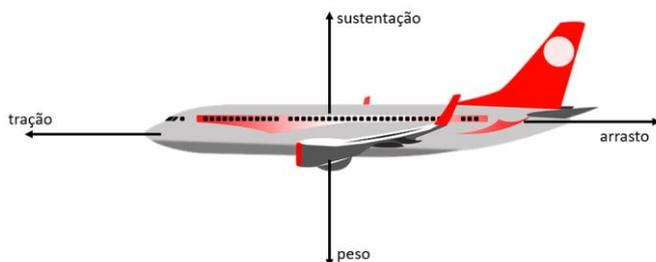
Considere uma situação em que o avião se move em linha reta na horizontal com aceleração maior que zero. A partir de um determinado instante, observa-se que a intensidade da força de tração passa a ter o mesmo valor da força de arrasto. Quando isto ocorre, podemos afirmar que a soma de todas as forças atuando sobre o avião é igual a zero, logo ele irá
